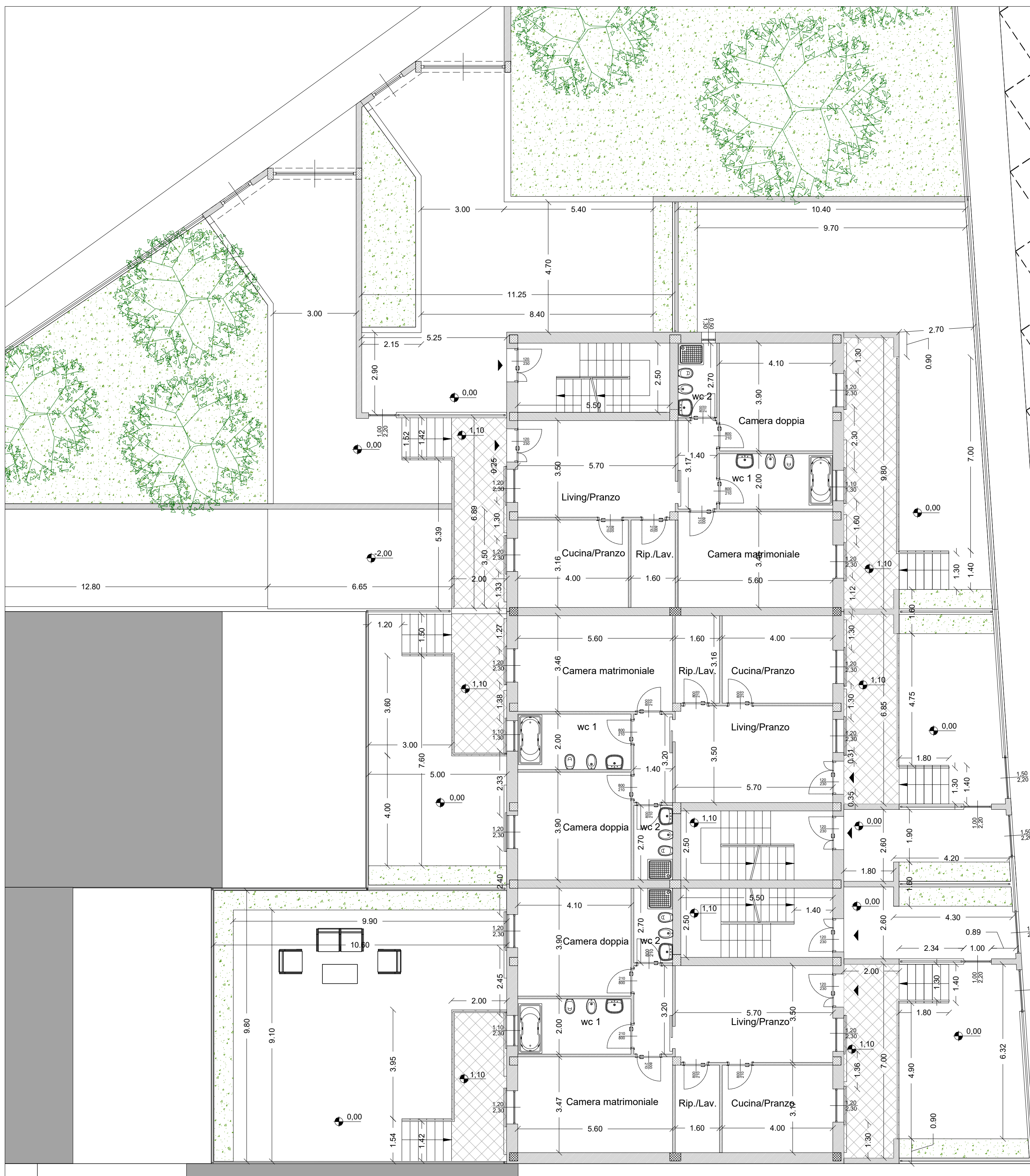
Tipologia C: planimetria di progetto Piano Terra
